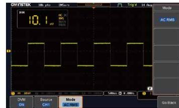
数字电压表 (DVM) 可以让用户在有限的资源下同时监控电压以及频率,亦能进行复杂的信号触发量测,使得研发的效率大大地提升,方便您掌握实际问题的发生以及变化。
