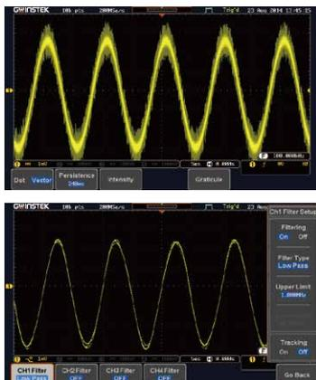
在电子电路测试中,工程师在测量信号时,常受噪声干扰影响所苦恼。GDS-2000E提供数字滤波器功能,可设定高通及低通滤波器。其滤波频率可依用户需求,分别设定各通道的滤波参数,亦可使用跟踪的功能,将所有通道的滤波频率快速地设为一致。
