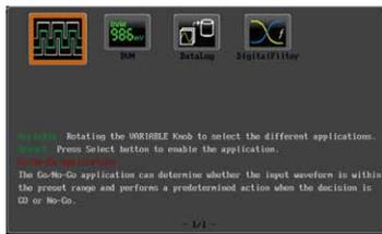
全新 GDS-2000E 系列支持的 APP 有可用来判断 Go/NoGo 的限制线功能、DVM 精确电压表、长时间数据纪录功能、以及数字滤波器功能。
