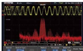
GDS-2000E系列的FFT功能最高提供1M点的显示分辨率，并提供3ms扫描更新率，让FFT的功能更趋近于用户的需要透过快速的更新率与波形搜寻功能，用户可快速且精确的得到频域的测试结果。用户可依据测试条件，选取各种窗口以做谐波频率的分析。GDS-2000E除了提供FFT分析，亦提供FFTrms，垂直调整与局部放大 (Zoom) 等功能。
